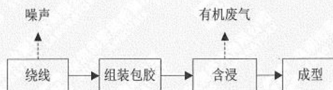
图 2-4 项目工艺流程及产物环节图
