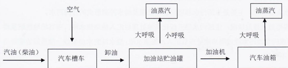
图 3-1 工艺流程及产污节点图
