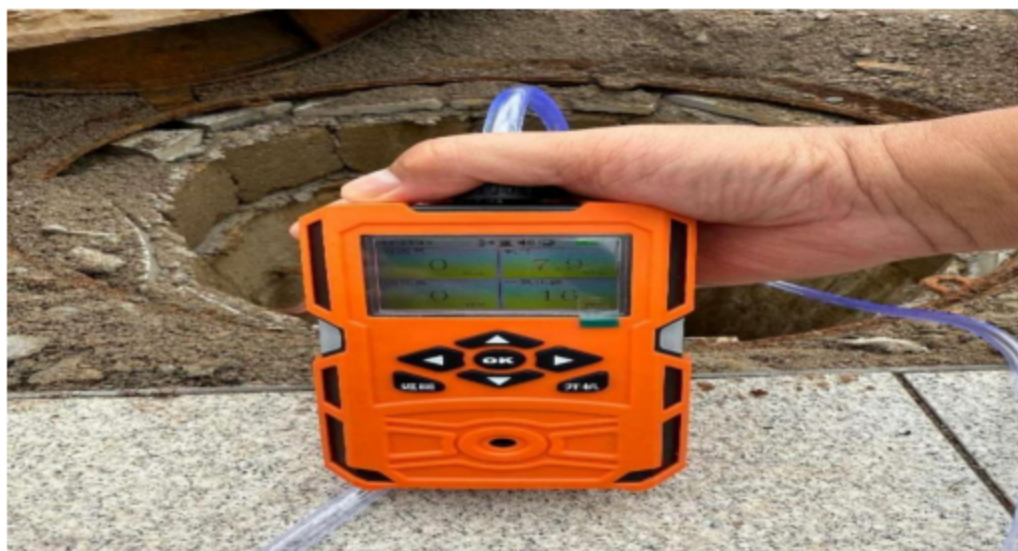
图 5 检修井内气体检测示意图
