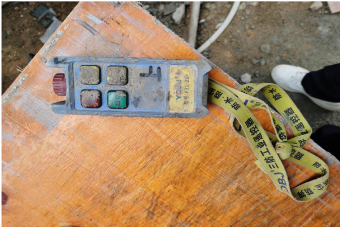
图 5 事发 2#楼物料提升机遥控器图
