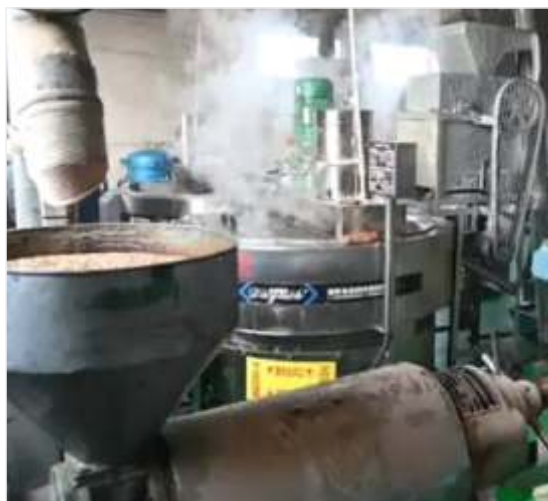
现象:住宅改用作家庭作坊、安装重型设备 判断:存在安全隐患
