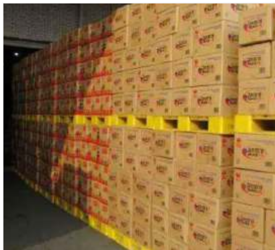
现象:住宅用作仓库,大幅增加楼面荷载 判断:存在安全隐患
